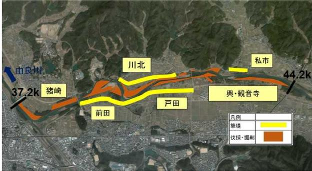
図-3. 河道掘削及び築堤位置
