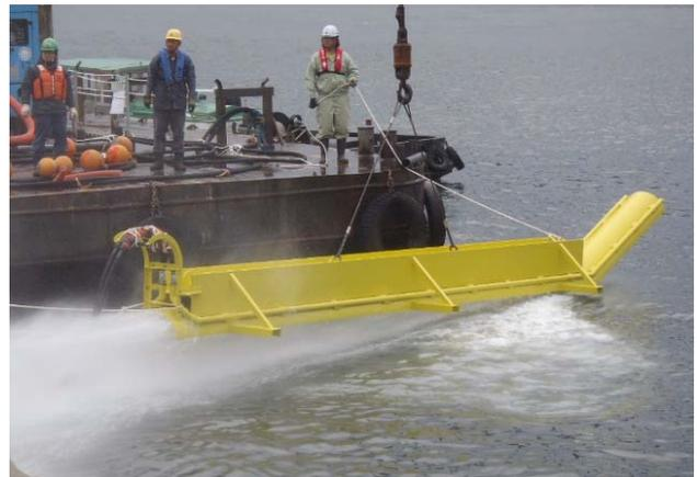
写真-3 水底土砂移送装置③ 試運転状況
