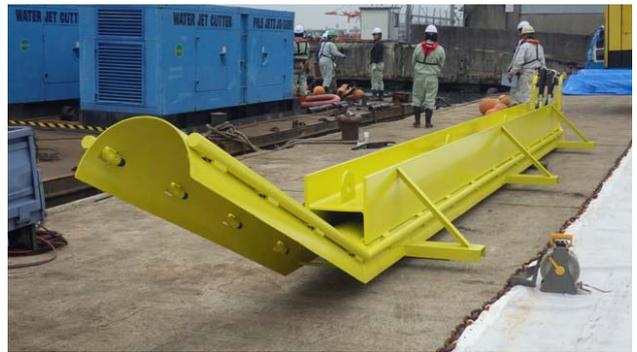
写真-1 水底土砂移送装置①
