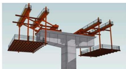
図-3 ワーゲンによる張出架設
