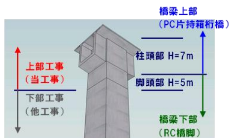
図-1 橋梁上下部工の分類
