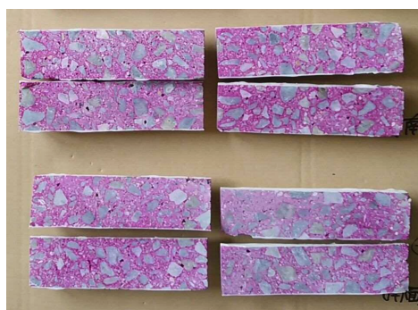
写真-5 中性化深さ試験状況
