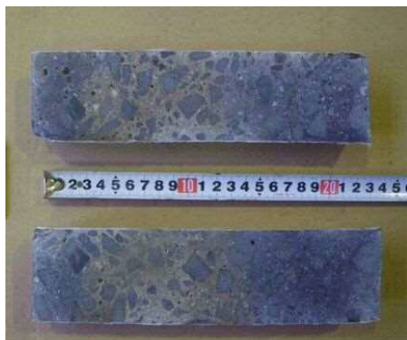
写真-4 塩化物イオン浸透試験状況
