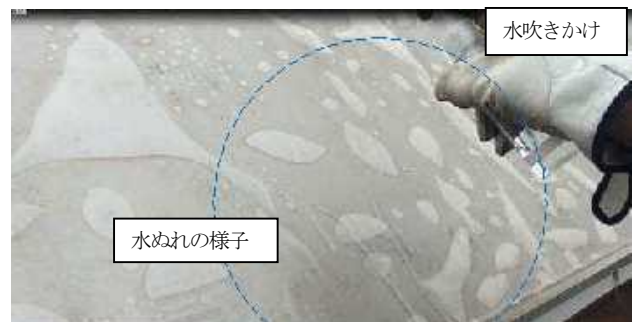
写真-6 落雪箇所での光触媒機能確認試験
