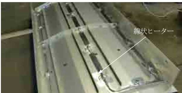
写真-8 パネルに設置されている線状ヒーター
