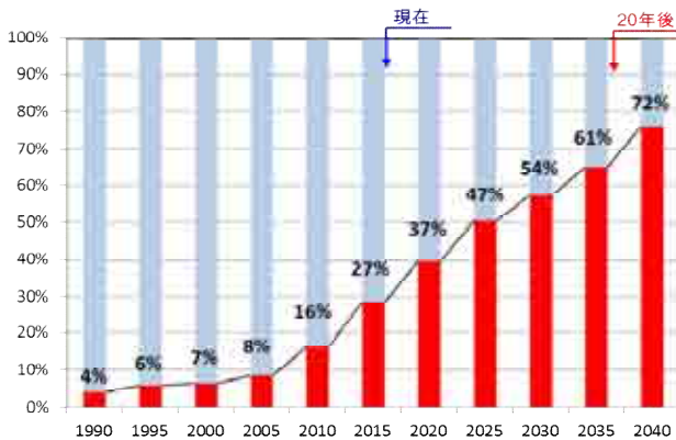
図-1 近畿管内直轄橋梁 架設50年超過割合
