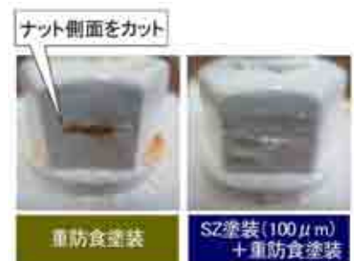
図-3 高力ボルトナット部の塩水噴霧試験結果 (塗装仕様，1,500時間経過後)
