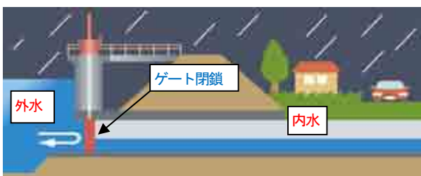
図-2 外水上昇時の樋門状況（ゲート閉鎖）
