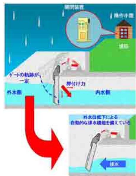
図-7 引上げ式門柱レスゲートの機能
