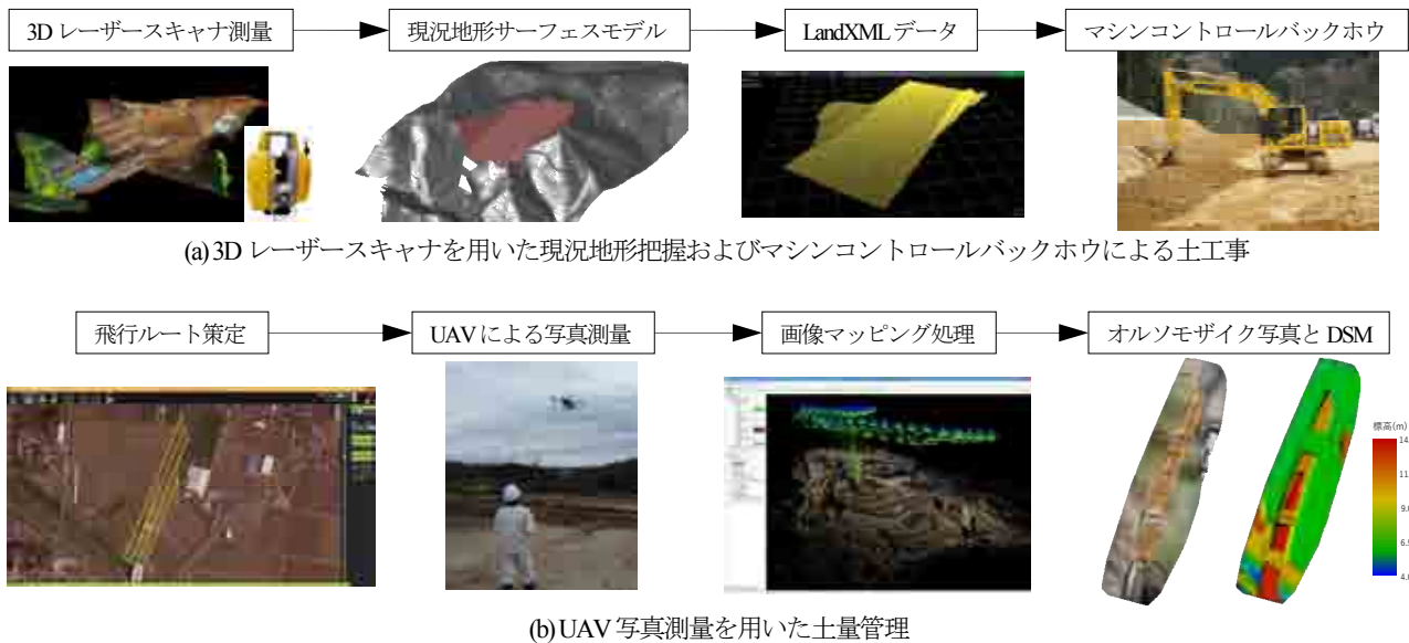
図-1 マシンコントロールバックホウによる自動化施工およびUAV写真測量による土量管理の概要
