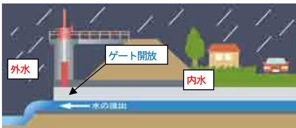
図-1 平常時の樋門状況（ゲート開放）
