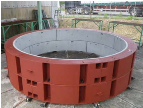
写真-6 SSPC工場検査（2リング組立検査）
