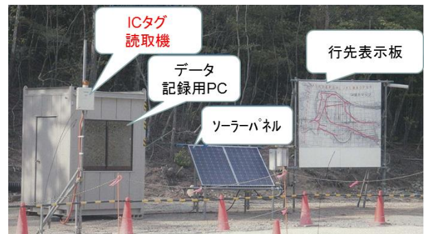
図-3-4 ダンプ入場管理システム概要図
