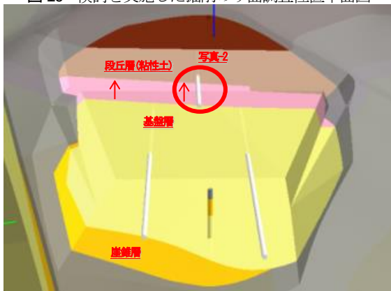
図-11 坑口掘削のり面CIMの例
