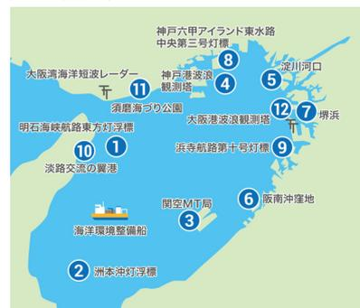
図-1 水質定点自動観測機器の配置図
