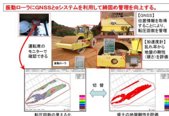
図-3-3 振動ローラ締固め管理
