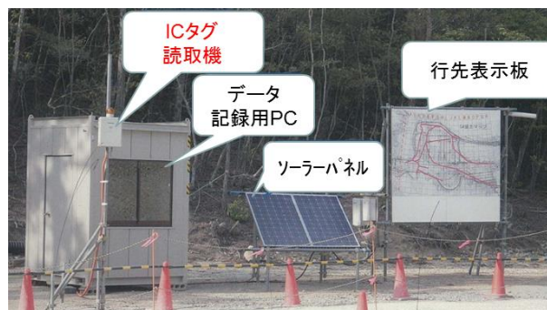
図-3-4 ダンプ入場管理システム概要図
