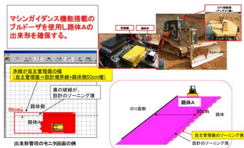
図-3-2 ブルドーザ巻出し管理
