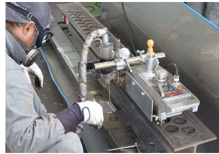
図-11 自走式台車へのスプレーガン設置例
