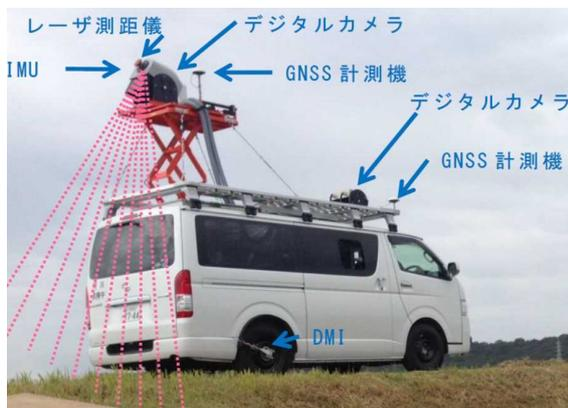
図1 使用したMMSの外観
