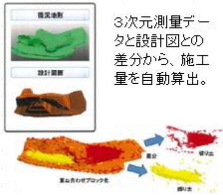
写真-4 3次元測量データによる設計・施工計画
