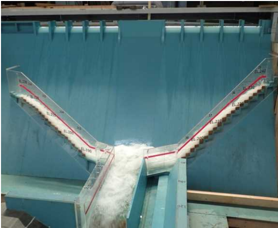
図-6 非常用洪水吐きでの放流能力確認状況
