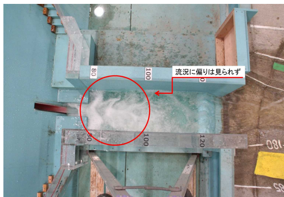
図-14 減勢工部の流況(180m 3 /s放流) 上から
