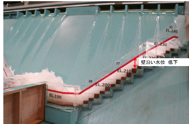
図-9 右岸堤趾導流部の流況(ブロック有り)
