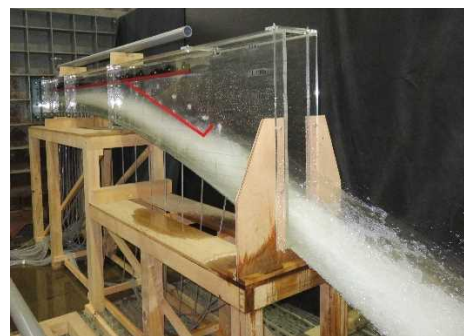
図-16 常用洪水吐き (1/20模型) の流況
