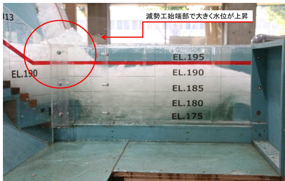
図-13 減勢工部の流況(1,400m 3 /s放流) 横から
