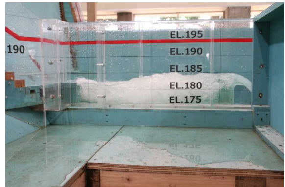
図-15 減勢工部の流況(180m 3 /s放流) 横から
