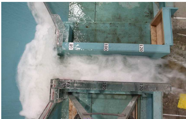
図-12 減勢工部の流況(1,400m 3 /s放流) 上から
