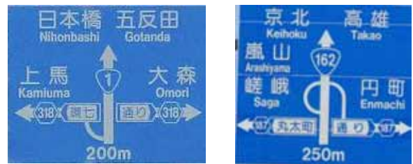
図14 案内標識（立体交差の表示）
