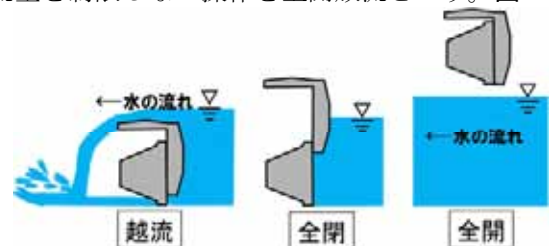
図-2 現洗堰のゲート操作
