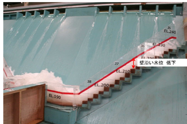
図-9 右岸堤趾導部の流況(ブロック有り)
