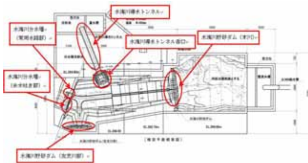
図-18 水海川分水施設模型図面（原案）
