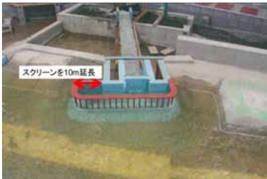
図-22 導水トンネル呑口部(改良形状)
