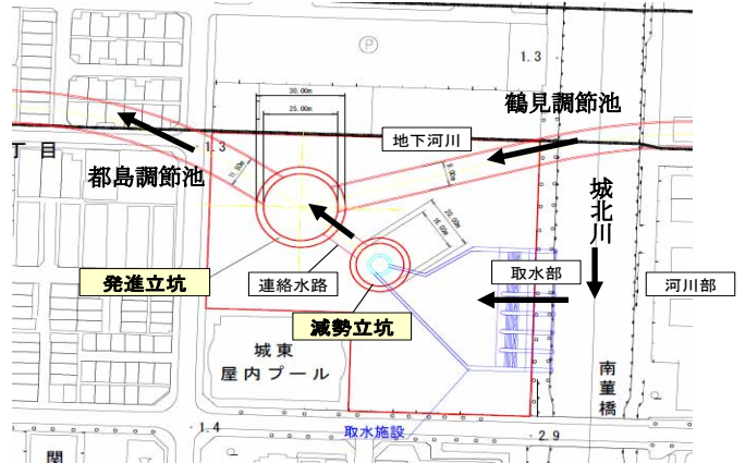
図-4.2 ドロップシャフト型減勢立坑の場合のレイアウト
