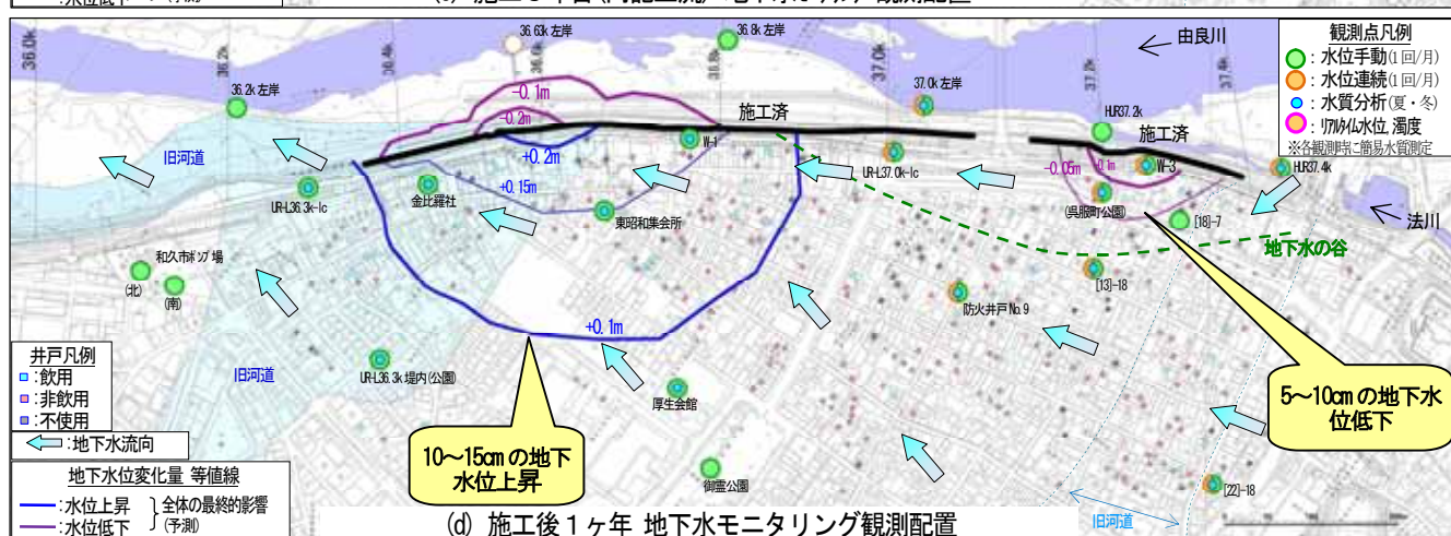
図-18 年度毎の地下水モニタリング観測配置図
