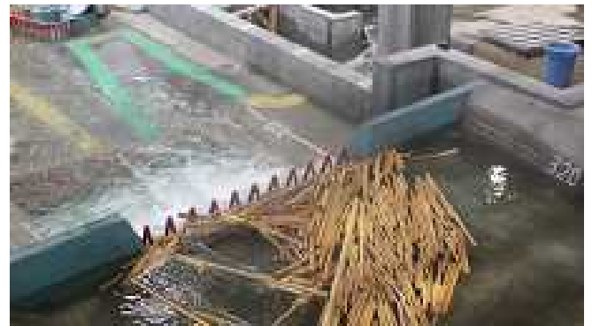
図-23 貯砂ダムの流木実験
