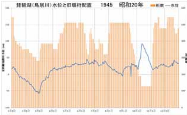
図-7 水位と堰桁配置 (昭和 20 年)
