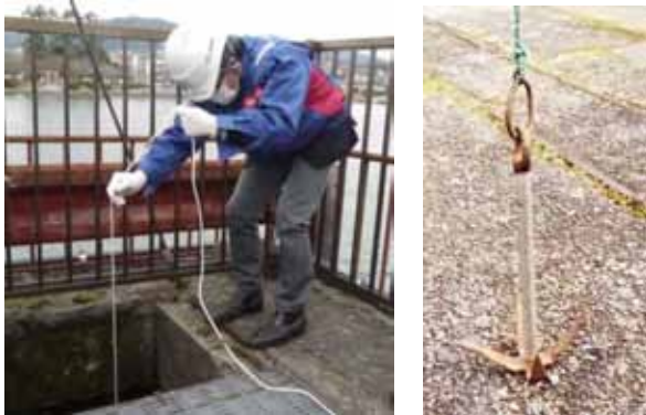
図-19 打音調査状況（左）と使用した碇（右）
