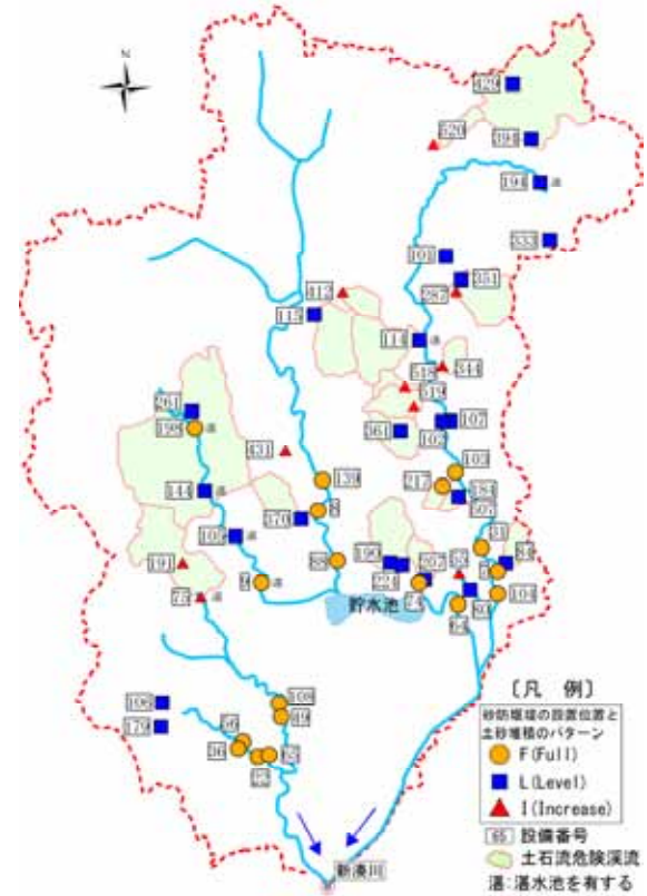
図-10 流域における砂防堰堤の堆砂状況
