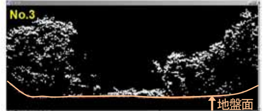
図-9 3次元点群データでみた堆砂地上に堆積した流木
