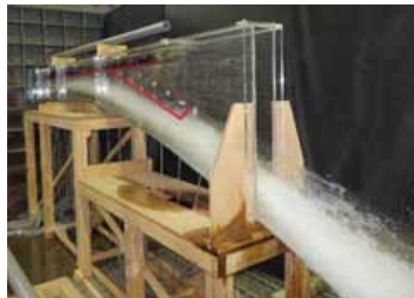
図-16 常用洪水吐き(1/20模型)の流況
