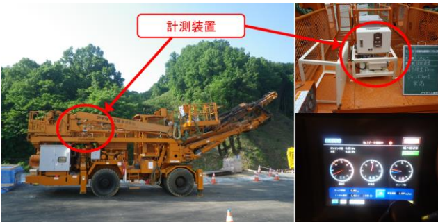
写真3 ドリルジャンボへの機器設置及び計測画面
