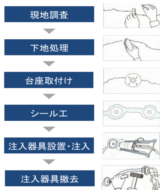
図-1 低圧注入工法の施工フロー
