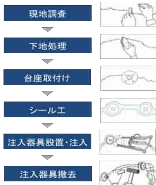
図-1 低圧注入工法の施工フロー
