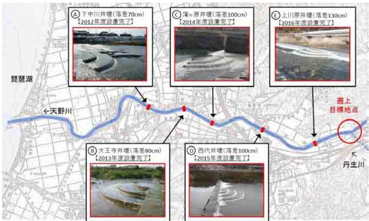
図-3 天野川に設置した棚田式魚道
