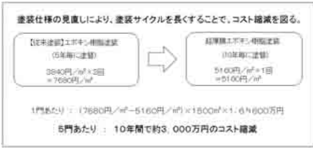
図3 超厚膜エポキシ樹脂塗装によるコスト縮減
