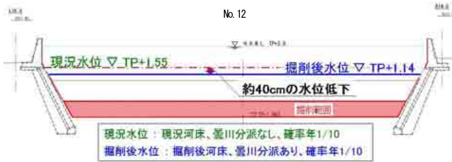
図-5 河道掘削による水位低減効果 (No. 12)
