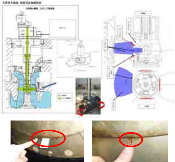
図-6 インペラハブと漏油の状況
