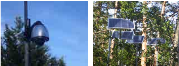
写真-9 ソーラー電源供給によるWEB定点カメラ
