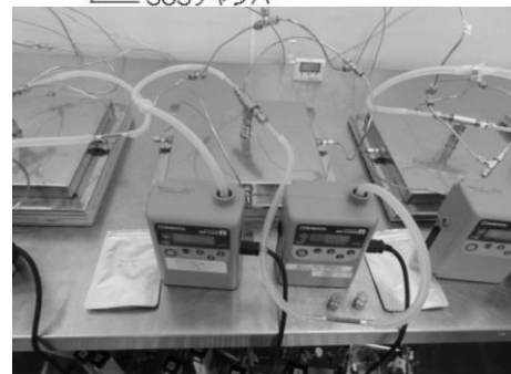
図9. 内装材からの化学物質発生量確認装置
