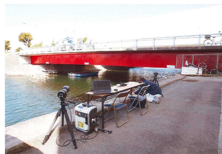
写真4 サンプリングモアレ計測イメージ
