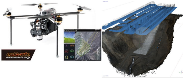
図-3 UAVと撮影航路イメージ
