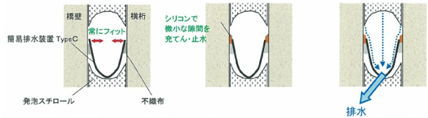
図-2 排水樋の設置断面イメージ
