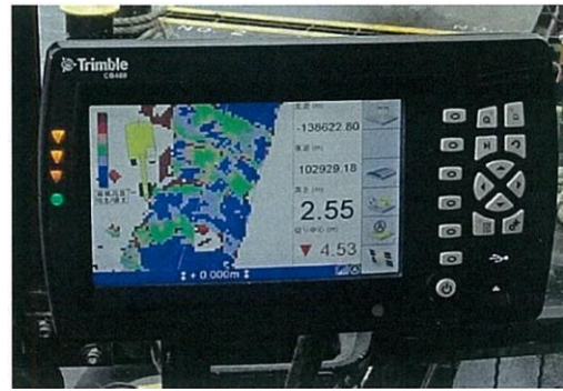
図-4 バックホウの位置を示したモニター
