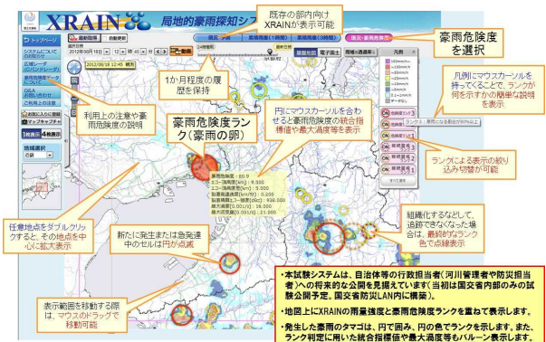
図-5 局地的豪雨探知システムの表示画面
