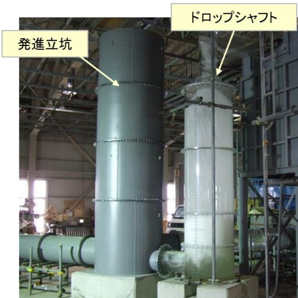
図7 水理模型実験の様子 (ドロップシャフト型減勢工)
