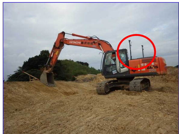
写真-4 バックホウガイダンス器具取付
