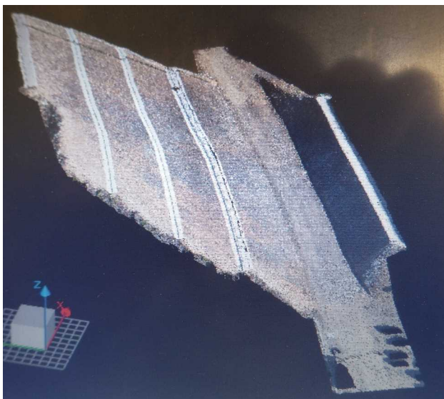
図-7 施工完了3次元測量結果
