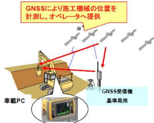
図-5 GNSSによるバックホウガイダンスイメージ
