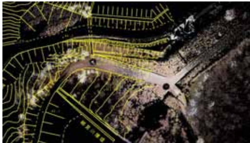
図-17 地上型レーザスキャナと数値地形図の比較
