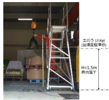
図-9 落下耐久性試験方法
