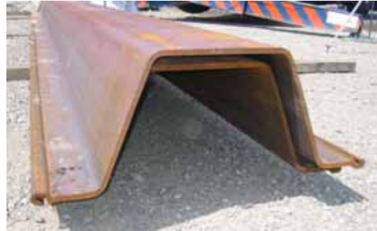
写真-8 現場納入したハット形鋼矢板（45H）
