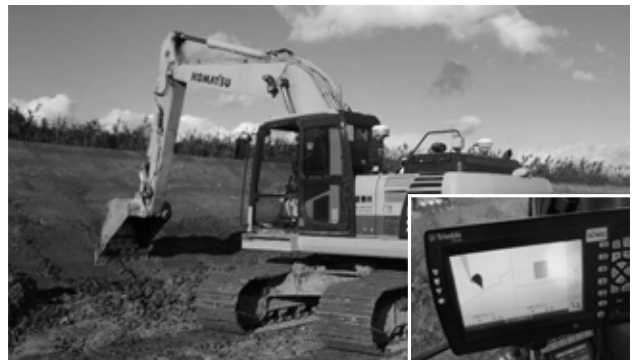
図-12 ICT建設機械（MGバックホウ）
