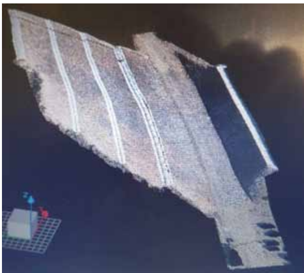
図-7 施工完了3次元測量結果
