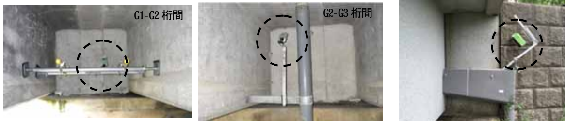
写真-6 効果観察用のインターバルカメラ設置状況(破線丸部がカメラ)
