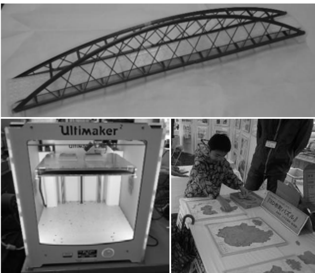
図-14 導入した3Dプリンタと造形物（橋梁模型, 3Dパズル）
