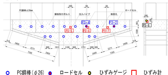
図-4 橋脚計測位置図
