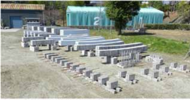
写真-1.1.2 近畿技術事務所に保管されている ASR 供試体の全景
