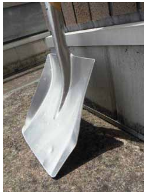
写真-10 除雪作業後のスコップ損傷状況
