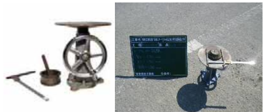
図-10 テーブルフロー値の測定器具と測定写真
