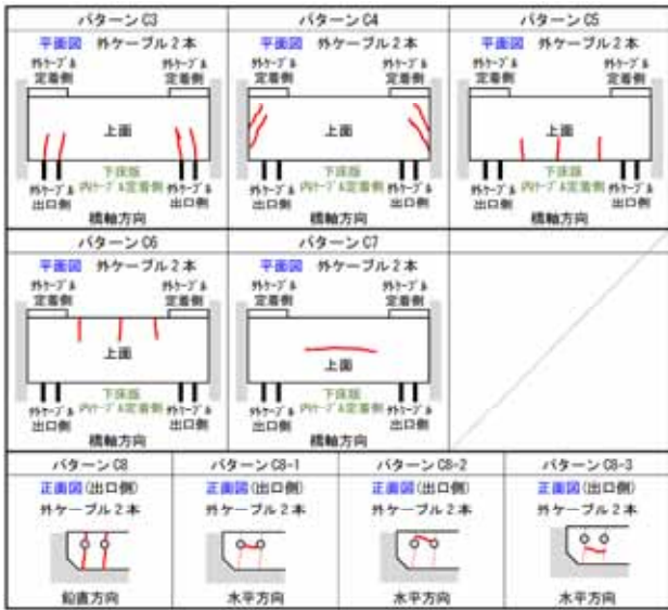
図-5 ひび割れパターン(外ケーブル定着部)
