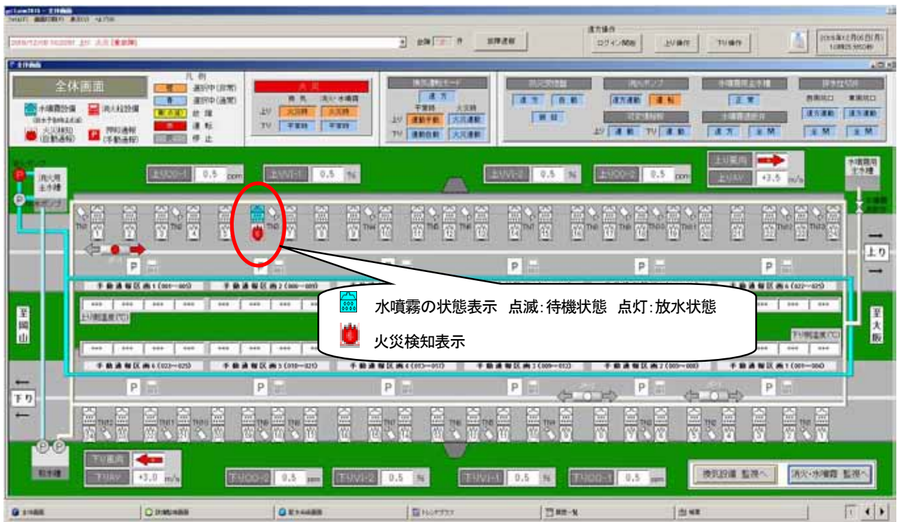
図-5 遠方監視操作設備画面
