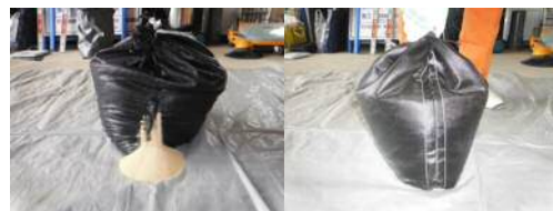
写真-18 従来土のう(左)と縮災土のう(右)の落下状況
