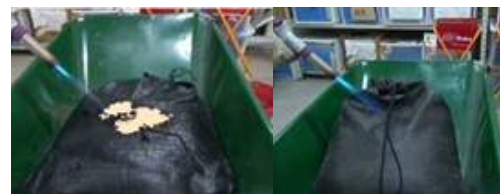
写真-20 PE製土のう(左)と縮災土のう(右)の燃焼性
