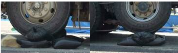
写真-17 従来土のう(左)と縮災土のう(右)の大型車による耐久性
