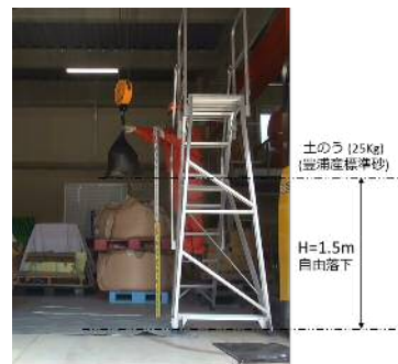
図-9 落下耐久性試験方法
