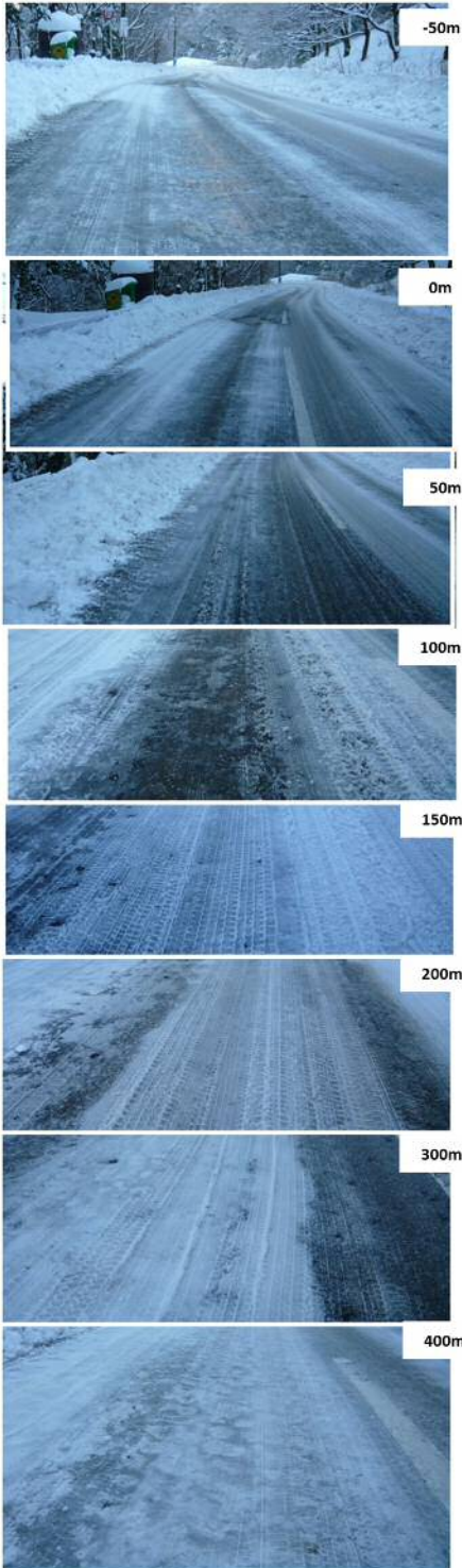
写真-3 観測点の路面の改質状況
