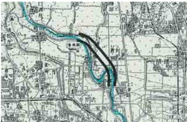
図-3 利倉捷水路工事
