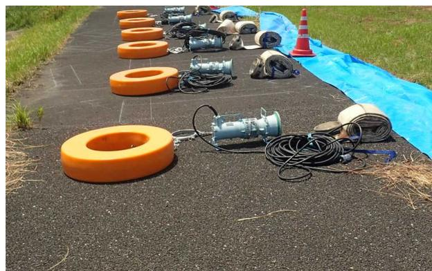
図-2 排水ポンプ車に搭載している排水ポンプ
