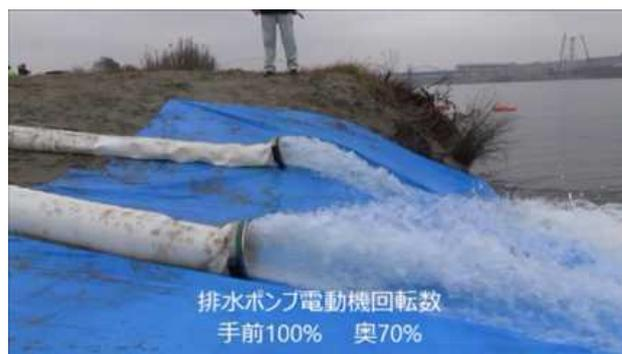
図-7 排水量低下確認の試験状況
