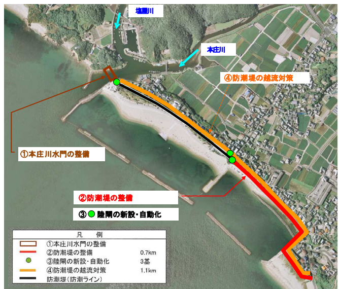
図-1 位置図、阿万港における津波対策の概要
