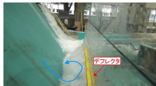
図-18 張り出し長さ0.5mにおける流況
