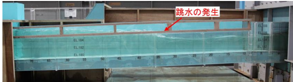
図-26 河床部放流設備内の流況 (流量:180m 3 /s)
