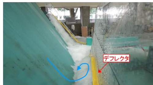
図-19 張り出し長さ1.0mにおける流況
