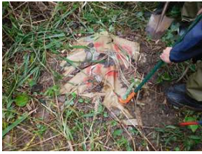
図-14 防草シートによる成長抑制実験
