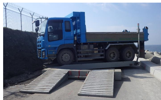
写真-2 ターンテーブル使用状況
