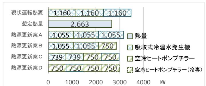
図-13 熱源機器構成（冷房熱量）
