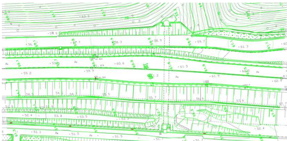
図-8 航空写真による図化成果と UAV 写真による図化成果の重畳
