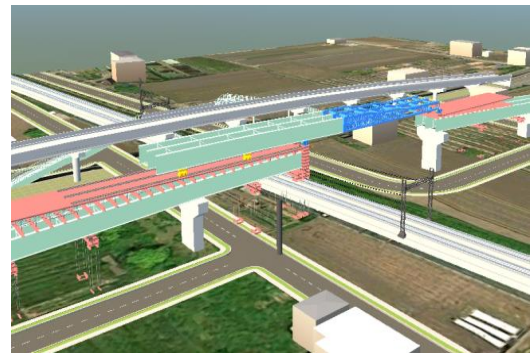
(a) 送り出し架設
