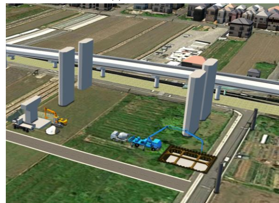
(b) 下部工躯体施工時
