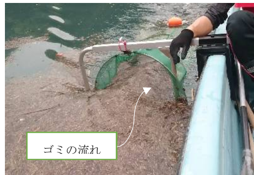
写真-15 船の前進走行に伴う自動的なごみ回収
