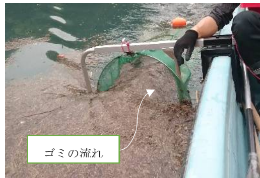
写真-15 船の前進走行に伴う自動的なごみ回収
