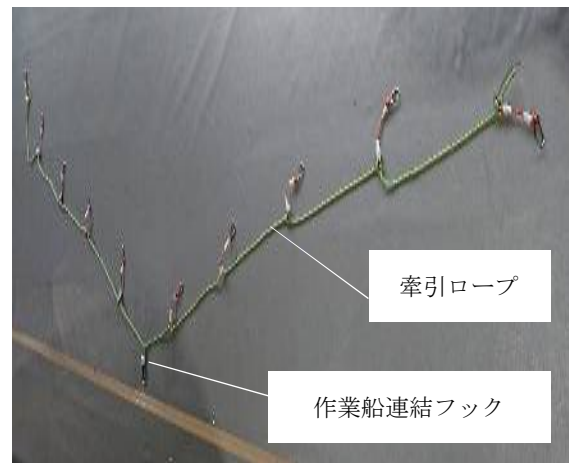
写真-21 作業船による回収ネット10個用牽引ロープ
