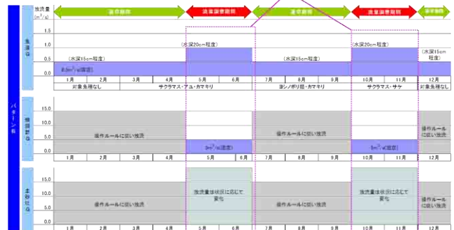
図-7 意見交換会で確認した試行運用の放流パターン
