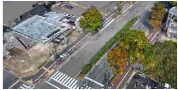
図-4 手動操縦の写真から作成した三次元画像
