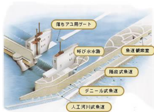
図-1 鳴鹿大堰の魚道
