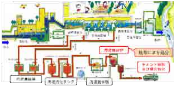
図-2 洛西浄化センターの処理フロー
