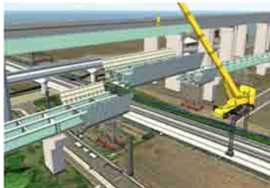
(b) トラッククレーン架設
