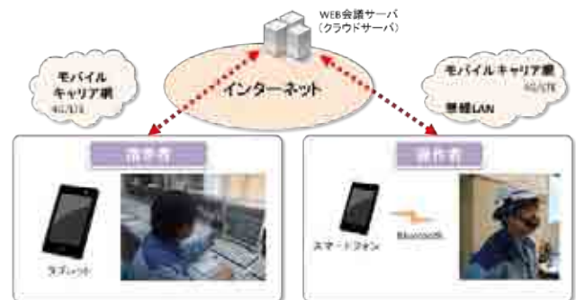
図-5 HMDを使用した業務支援システム構成図
