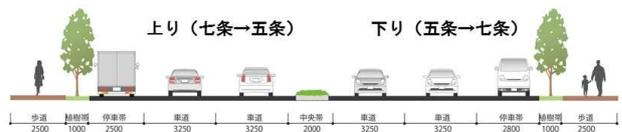
(図-7) 現況横断面図 (烏丸五条～烏丸花屋町)
