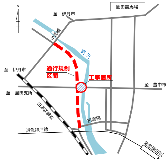
図-2 通行規制の対象区間
