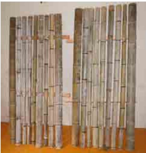
図-10 竹の被覆工(設置前)
