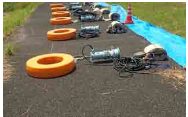
図-2 排水ポンプ車に搭載している排水ポンプ
