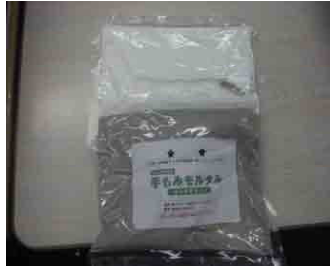
写真-11 手もみモルタル
