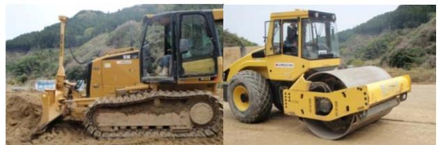
写真-1 MC搭載ブルドーザによる敷均し状況(左)
