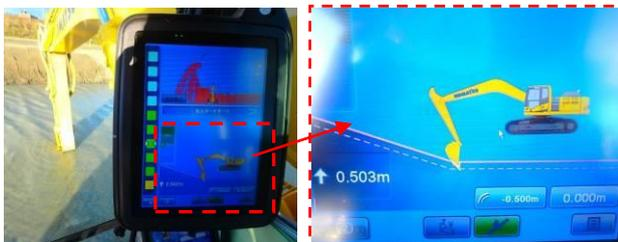
図-15 バックホウモニター
