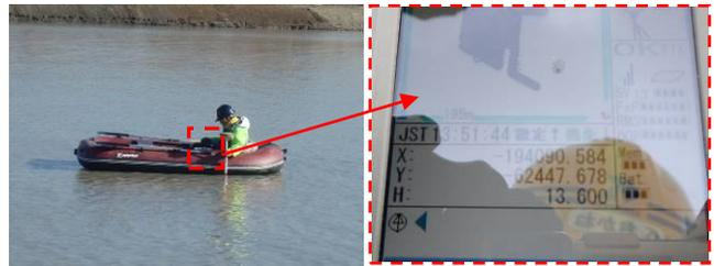
図-16 RTK-GNSSによる出来形測量
