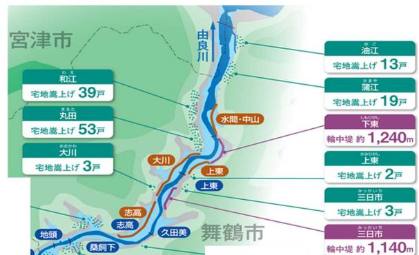
図-2 由良川緊急治水対策(下流部)
