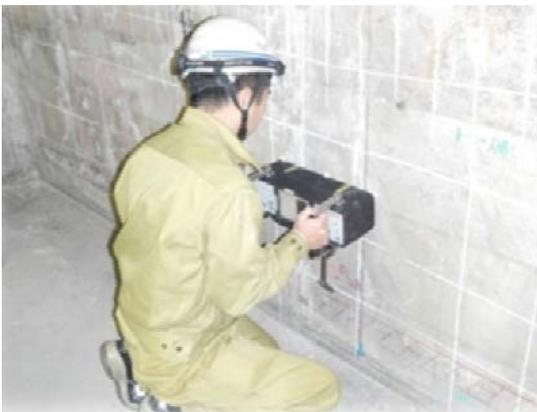
写真-12 超音波探査の状況
