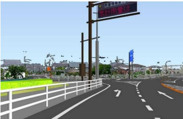
図-16 計画案（国道365号から県道への左折レーン）
