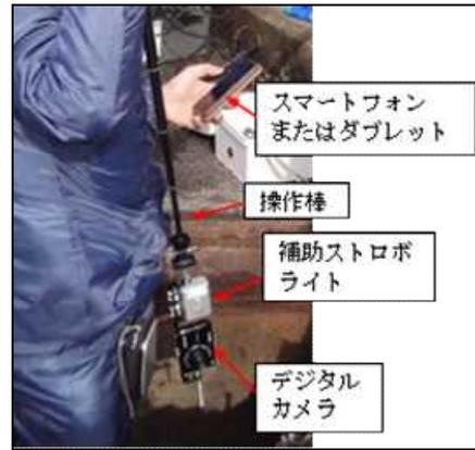
写真-2 挿入式カメラ<sup>2)</sup>
