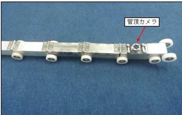
写真-1 ガイド挿入式カメラ<sup>2)</sup>
