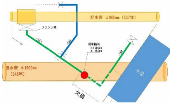
図-6 今回事象において想定される損傷原因
