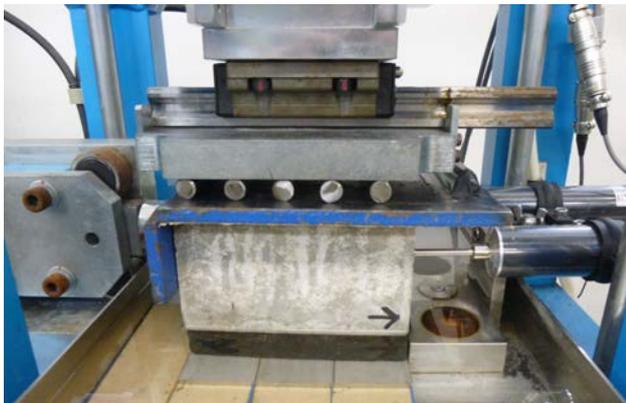
写真-4 摩擦試験装置
