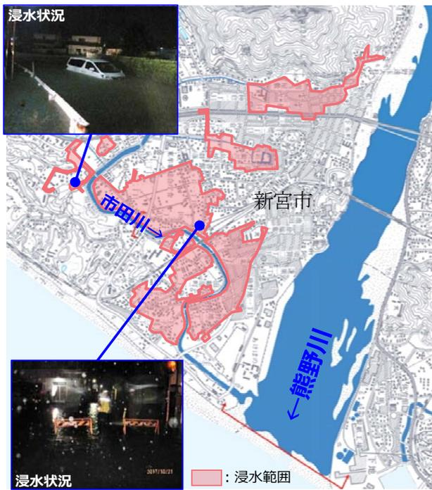
図-2 市田川浸水範囲（2017年10月台風21号出水）
