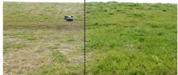
図-11 ロボット除草機による除草作業の様子
